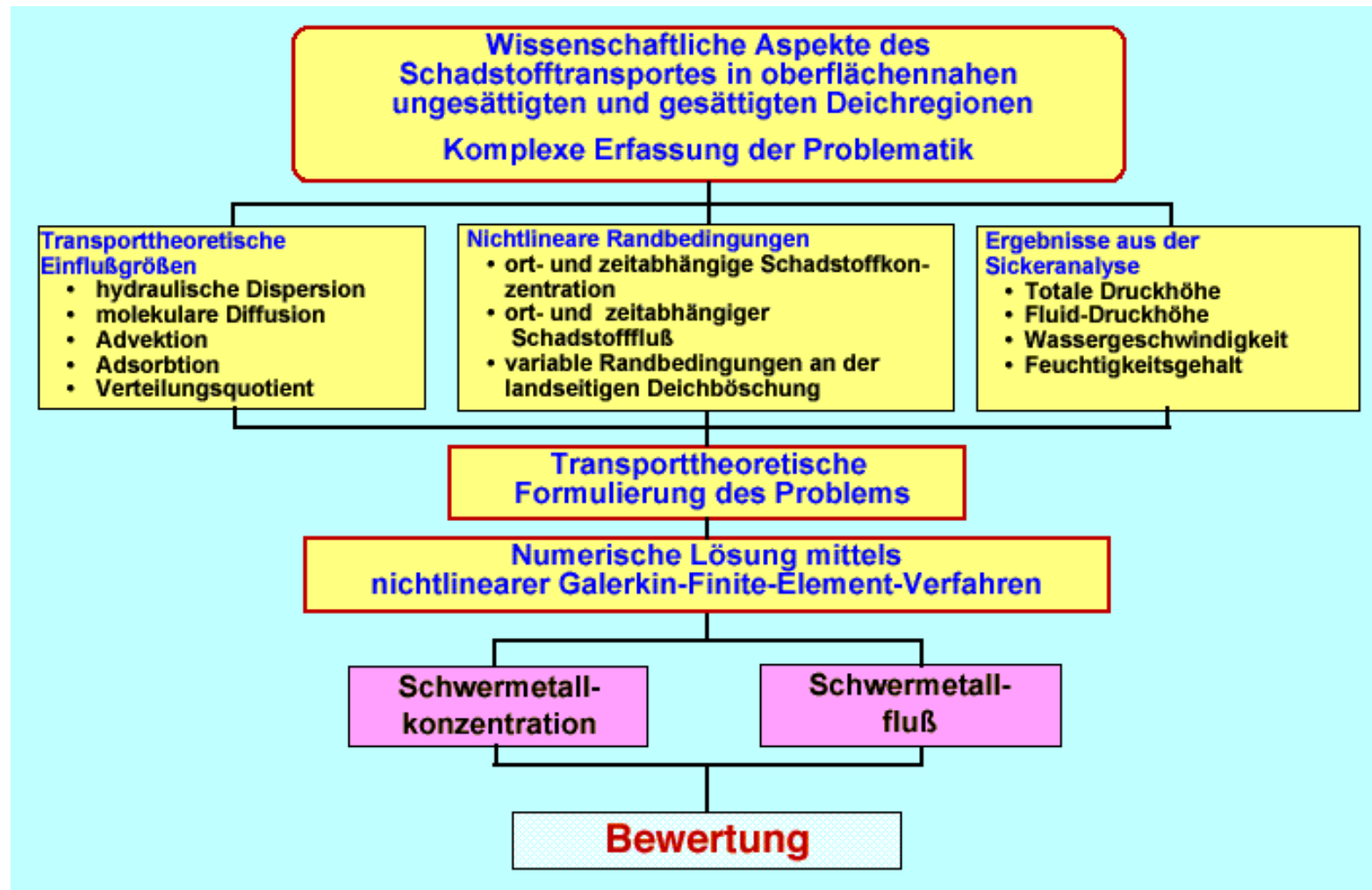
Bild 6: Struktur der wissenschaftlichen Aspekte bei einem Schadstofftransport
